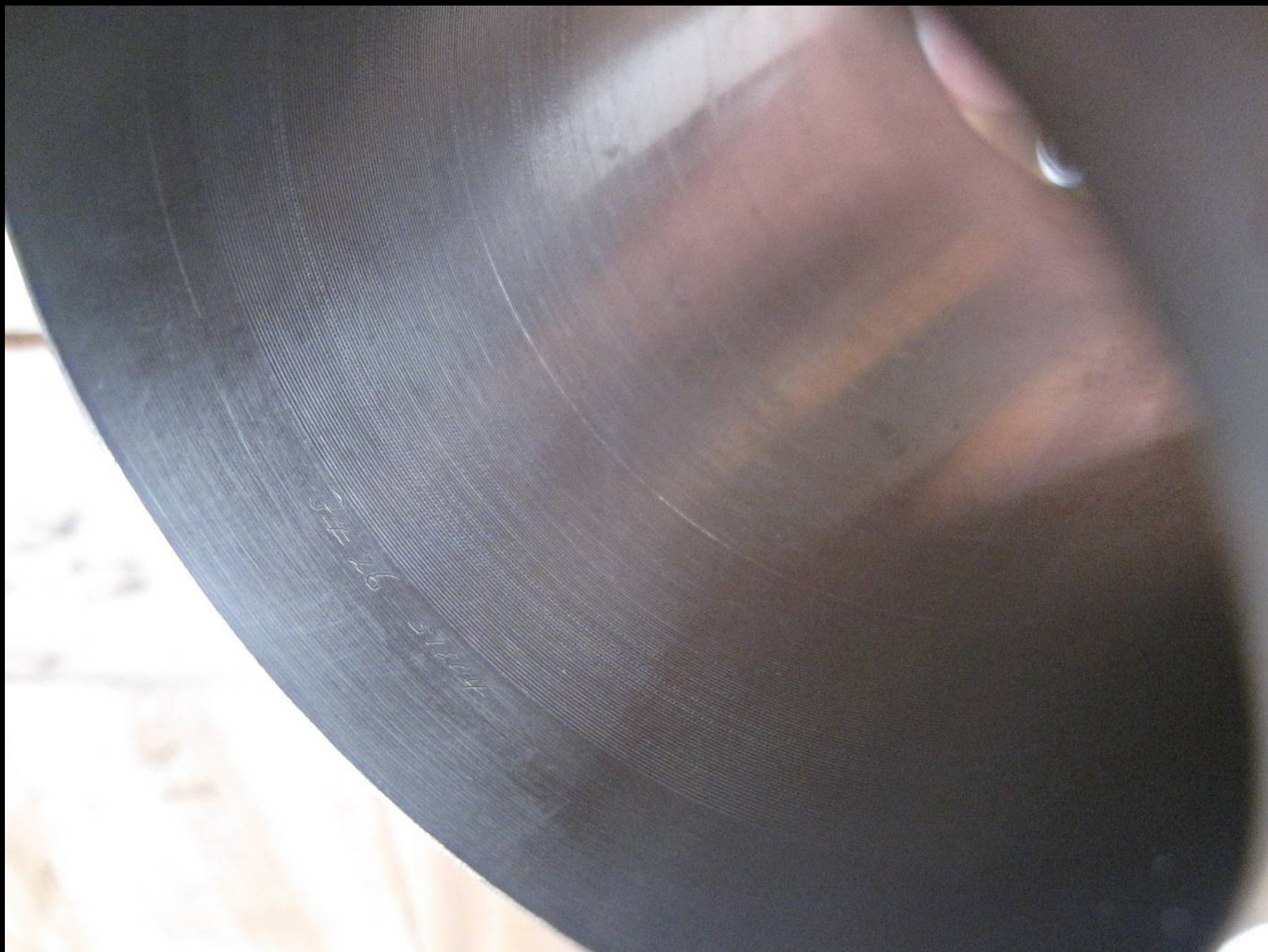
Moule à cylindres Columbia, en cuivre nickelé (vers 1904).
